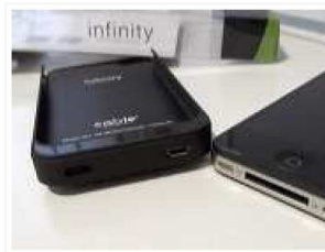
^ Qui vediamo la parte inferiore di batteria e iPhone 4 a confronto: sparisce la presa dock per lasciare posto al quella microUSB. Per ospitarlo nei dock standard dovete rimuovere la batteria oppure rimediare con un collegamento alla presa audio ausiliaria con un mini-jack
