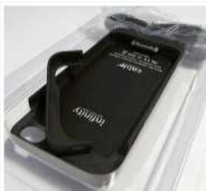
^ La culla in plastica contiene i due pezzi di cui e' composta la custodia-batteria. Notare il connettore dock che "emerge" dal fondo della custodia
