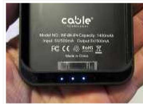
^ In questa immagine è evidente il sistema di controllo della carica: a sinistra c'e' il bottone da premere per la verifica e al centro i 4 piccoli led blu per visualizzare il livello
