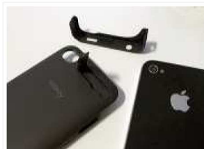
^ Qui vediamo la parte inferiore di batteria e iPhone 4 a confronto: sparisce la presa dock per lasciare posto al quella microUSB. Per ospitarlo nei dock standard dovete rimuovere la batteria oppure rimediare con un collegamento alla presa audio ausiliaria con un mini-jack
